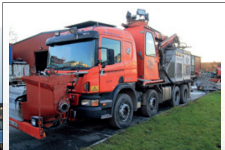
En av de sprutbetongrobotene Entreprenørservice har. Alle er bygget på Scania-chassis. Legg merke til hytta bak Scania-hytta. Den ble utviklet som et HMS-tiltak. Her sitter operatøren trygt og komfortabelt under arbeid.
